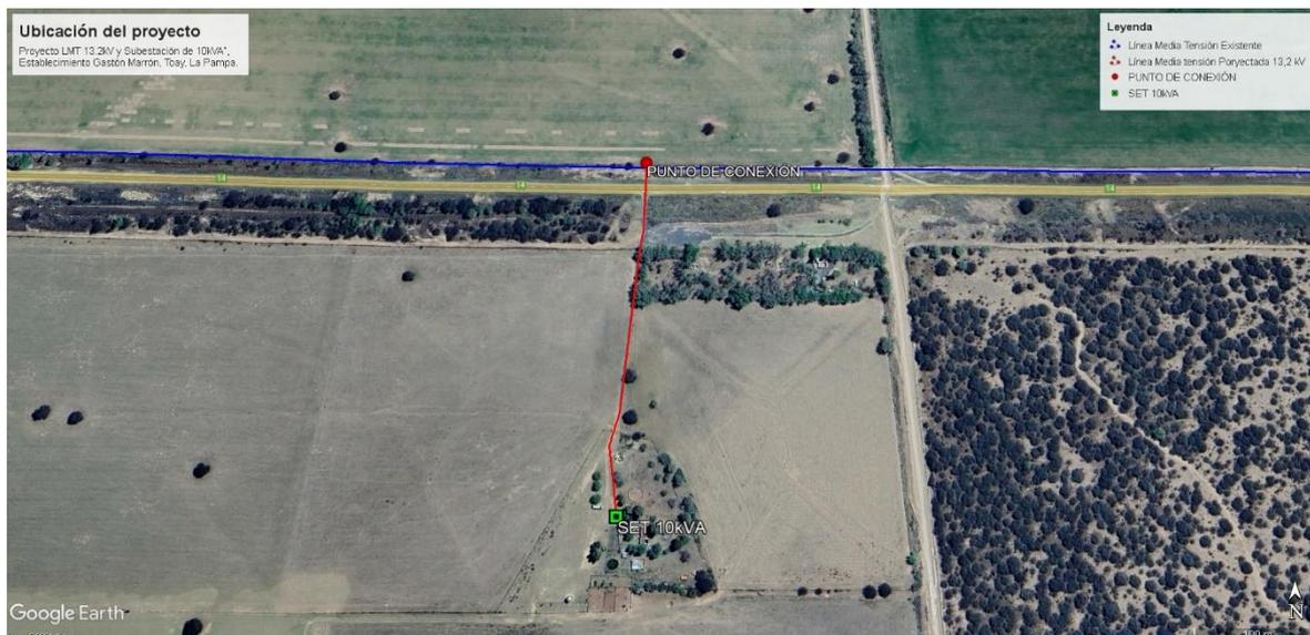
**Figura N°1.** Ubicación del proyecto a realizar. Traza azul: línea de media tensión existente. Traza roja: línea de media tensión proyectada
